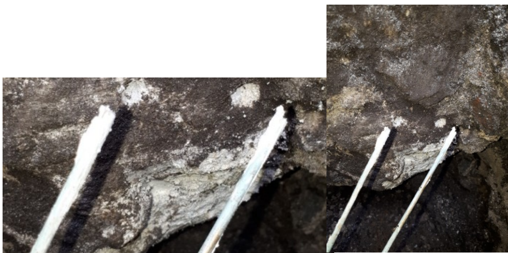
Fot. 64 Lokalizacja j.w.: po wyjęciu z otworów pomiarowych sondy oblepione mokrym urobkiem.
