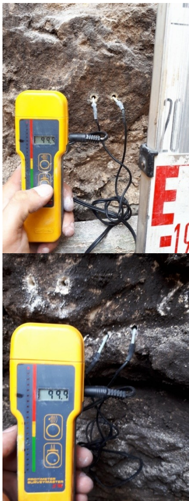
Fot. 65, 66, 67 Lokalizacja j.w.: pomiary wilgotności na poziomach -1,5 m/ - 2,0 m oraz -2,5 m ppt na głębokości 30 cm w ścianie fundamentowej – wyniki >15%.
