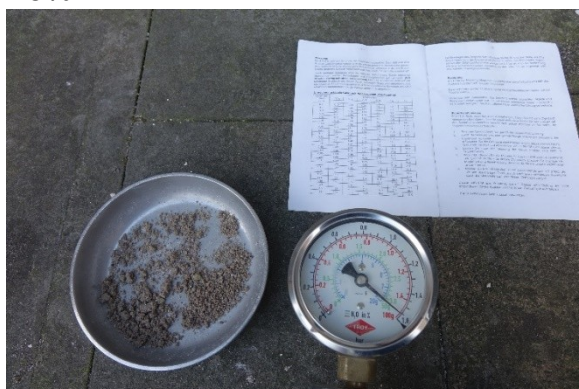
Fot. 68, 69 Lokalizacja j.w.: pomiar wilgotności strukturalnej pobranych próbek metodą karbidową z odkrywki O1 na różnych poziomach ściany fundamentowej – wyniki: po lewej 13,8%, po prawej 15,8%.
