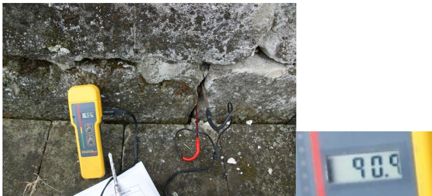
Fot. 27 Pomiar wilgotności strukturalnej, zaprawa w spoinach, odwiert na głębokość ok. 10 cm – wilgotność zaprawy > 15%.
