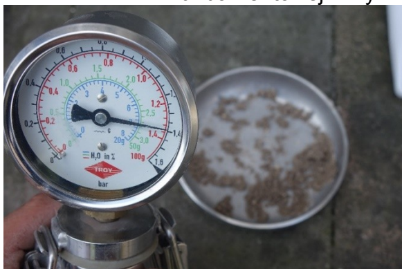
Fot. 68, 69 Lokalizacja j.w.: pomiar wilgotności strukturalnej pobranych próbek metodą karbidową z odkrywki O1 na różnych poziomach ściany fundamentowej – wyniki: po lewej 13,8%, po prawej 15,8%.
