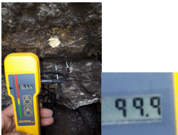
Fot. 63 Lokalizacja j.w.: pomiar wilgotności muru na głębokości 30 cm, poziom -0,5 m ppt – wynik: > 15%
