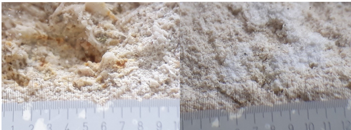
Fot. 80, 81 Ściany Kolegiaty: sole budowlane na powierzchni ciosów wapiennych, powiększenie - skala 1 mm.
