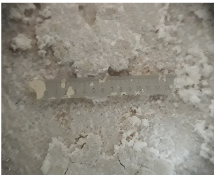
Fot. 84 Powierzchnia skorodowanego tynku renowacyjnego, na powierzchni zalegają złuszczone sole budowlane, ściana północna Kolegiaty, powiększenie – skala 1mm.
