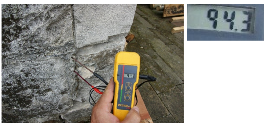
Fot. 26 Pomiar wilgotności strukturalnej, zaprawa w spoinach, odwiert na głębokość ok. 10 cm – wilgotność zaprawy > 15%.
