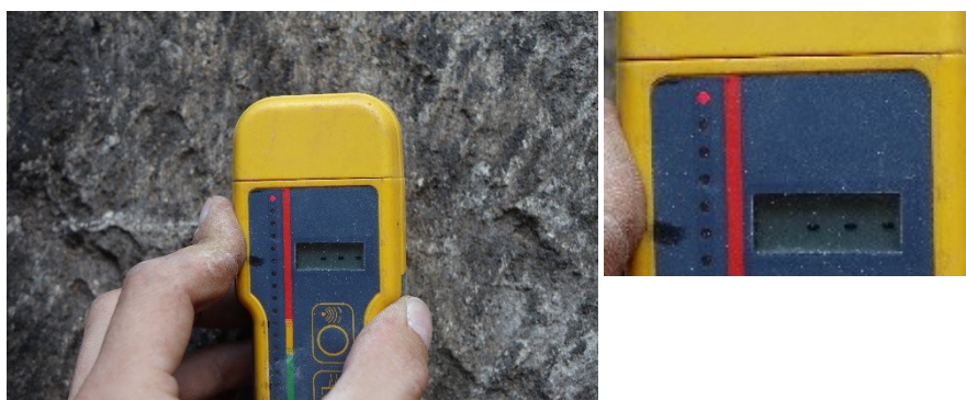
Fot. 74 Kolegiata, lokalizacja j.w.: pomiar wilgotności strukturalnej muru sondą radiową – wynik >15%.
