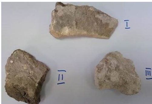
Fot. 75 Przykładowe próbki ciosów wapiennych pobrane do badań wilgotności ze ścian fundamentowych Kolegiaty – odkrywka O2.
