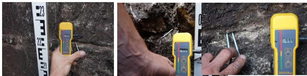
Fot. 70, 71, 72 Kolegiata, ściana północna - pomiary wilgotności na kolejnych poziomach, na głębokości 30 cm w ścianie fundamentowej – wyniki >15%.
